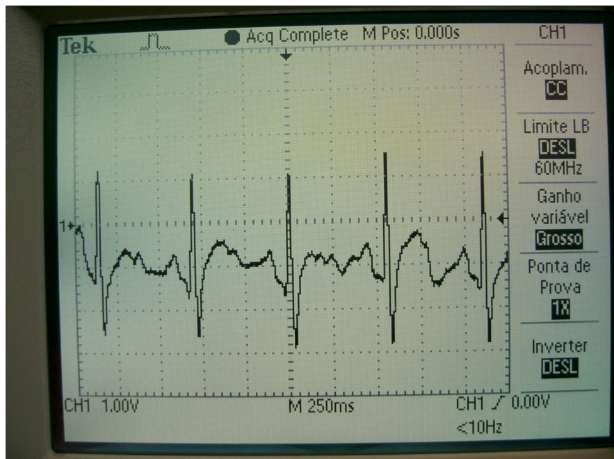
Figura 20.14: Resultado típico de um eletrocardiograma medido com o circuito das Figuras 20.11 e 20.13.
